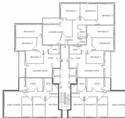
Etxebizitzien banaketa bi dorreetan. Dorre bat bestearekiko 180° biratuta dago. Distribución de las viviendas en las dos torres. Las dos torres están giradas 180° una respecto de la otra.
